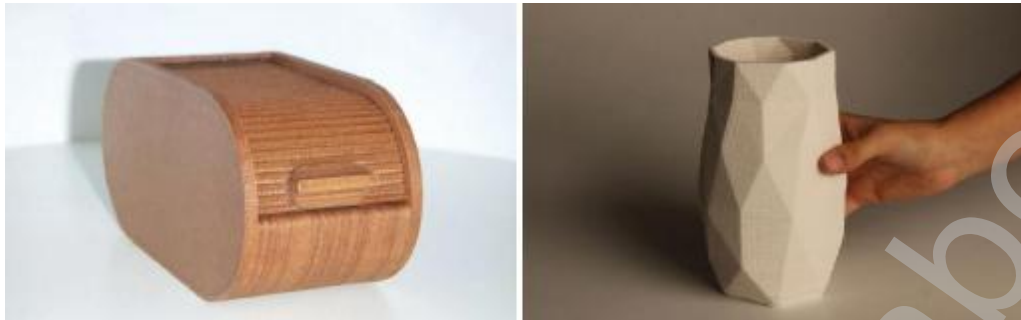
Filament z dodanimi vlakni lesa (levo), delci keramike (desno).
