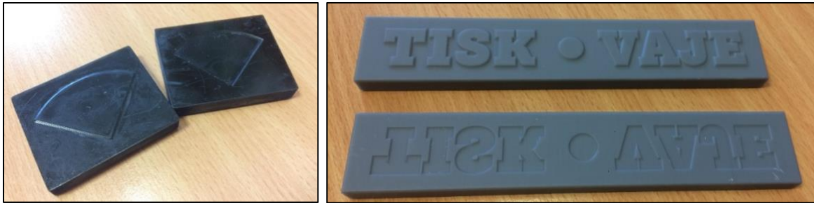
Slika 9: Primer tiskovnih form natisnjenih s 3D tiskom.
