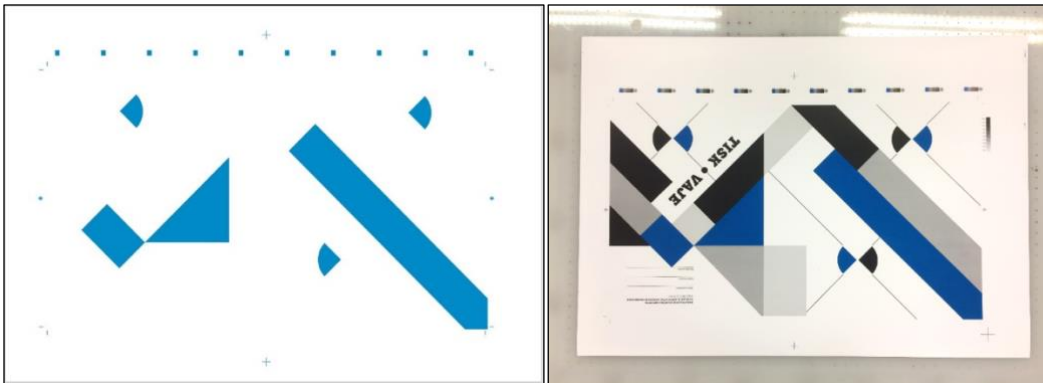
Slika 3: Digitalna predloga PANTONE barve (levo) in dotisk PANTONE barve na črno (desno).
