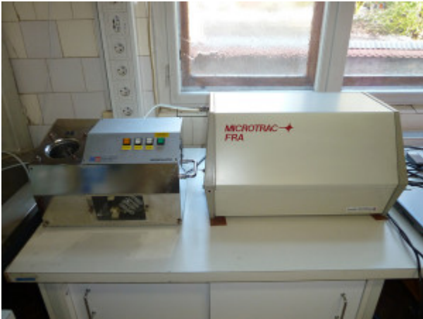
Laserski analizator velikosti delcev Malvern+
