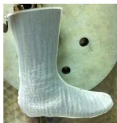
Nog 1: nogavica brez prekatov na krojnih delih. Posamezne krojne dele medsebojno, brez vmesnega prostora med krojnimi deli, povezujejo cikcak šivi.
