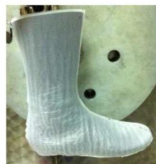
Nog 2: nogavica brez prekatov na krojnih delih. Posamezni krojni deli so medsebojno povezani z ravnimi šivi. Med posameznimi krojnimi deli je 8-mm razmik za šiv, ki ga tvorita dva sloja membrane.
