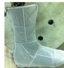
Nog 4: notranji in zunanji del nogavice vsebujeta 8 prečnih prekatov, širokih 5 mm, ki se križajo. Posamezni krojni deli so med seboj povezani z ravnimi šivi. Med posameznimi krojnimi deli je 8-mm razmik za šiv, ki ga tvorita dva sloja membrane.
