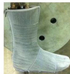
Nog 3: notranji in zunanji del nogavice vsebujeta 4 prečne prekate, široke 5 mm. Posamezni krojni deli so med seboj povezani z ravnimi šivi. Med posameznimi krojnimi deli je 8-mm razmik za šiv, ki ga tvorita dva sloja membrane.
