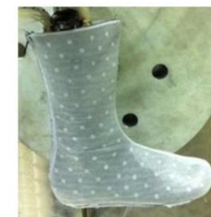
Nog 5: notranji in zunanji del nogavice sta v laminatu perforirana z luknjicami s premerom 6 mm. Delež površine luknjic je enak deležu površine prekatov Nog 3. Posamezni krojni deli so med seboj povezani z ravnimi šivi. Med posameznimi krojnimi deli je 8-mm razmik za šiv, ki ga tvorita dva sloja membrane.
