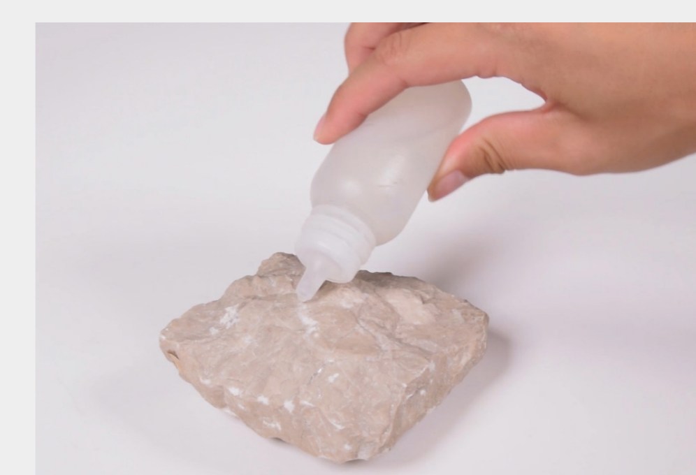
Slika 9: Preverjanje topnosti z uporabo HCl.
