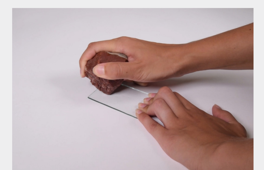
Slika 10: Določanje trdote s stekleno ploščico.
