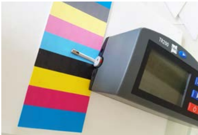
Slika 2: Testiranje odpornosti obešank in etiket na drgnjenje
