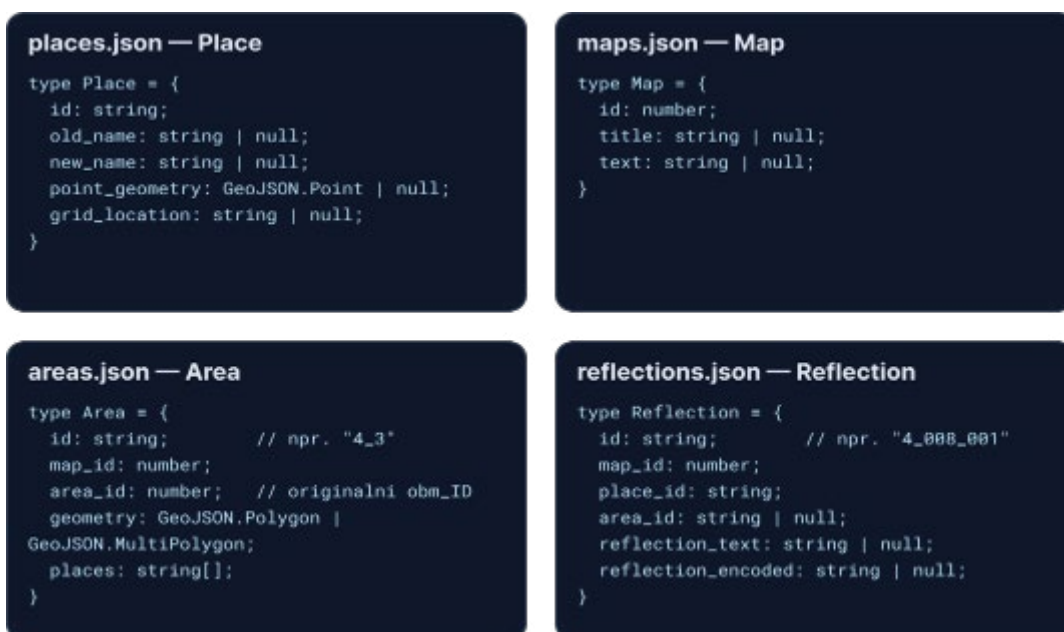
Slika 16. Shema končnega podatkovnega modela po agregaciji. Model sestavljajo štiri glavne entitete (Place, Map, Area in Reflection), med katerimi so vzpostavljene relacije, ki povezujejo reflekse s pripadajočimi kartami, kraji in območji ter omogočajo učinkovito iskanje in prostorsko vizualizacijo podatkov
