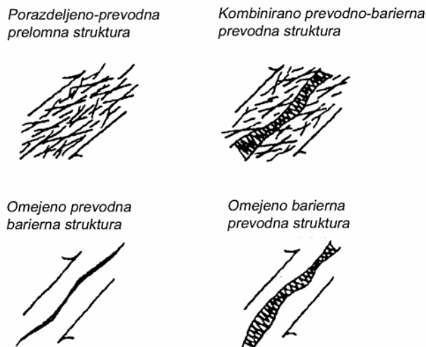
Sl. 2.9 Konceptualni modeli idealiziranih prepustnosti struktur prelomnih con (Caine et al., 1996; Lapanje, 2000).
