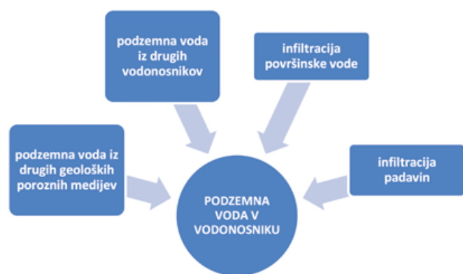
Slika 3: Prikaz odnosa med različnimi bilančnimi komponentami v vodonosniku.
