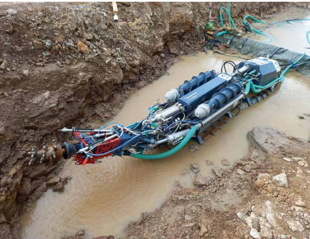
Delujoči prototip RM-1 v kamnolomu Ubja blizu kraja Rakvere v Estoniji. Foto: Gorazd Žibret.
