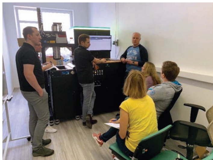
Izobraževanje operaterjev ob prevzemu AconityMINI. Levo delovna komora z laserskim sistemom. Desno računalniška in podporna oprema tiskalnika.
