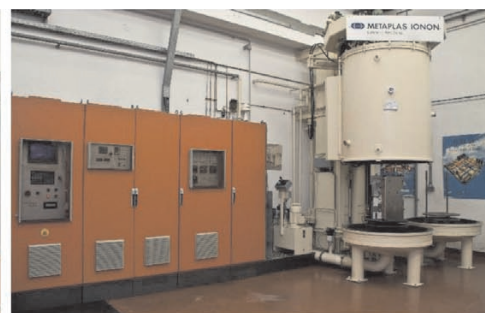
Slika 1. a) Eno komorna vakuumaska peč Ipsen VTTC324-R s homogenim plinskim ohlajanjem pod visokim tlakom in b) Peč za nitriranje v pulzirajoči plazmi METAPLAS-IONON
