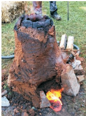
Peč na volka, izpust žlindre in pogled v notranjost založene peči
