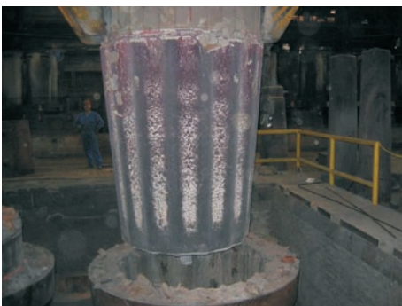
45-tonskega ingota po strjevanju, stripanje z mostnim dvigalom
