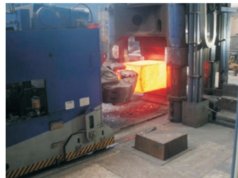
Končno kovanje izdelka iz 45-tonskega ingota jekla za plastiko UTOPNIN izmer 1310 x 1010 mm
