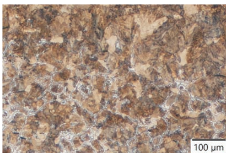
Mikrostruktura kovanega volka, perlitno področje s sekundarnim cementitom.
