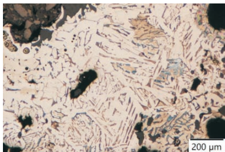
Mikrostruktura pridobljenega volka feritno perlitna mikrostruktura
