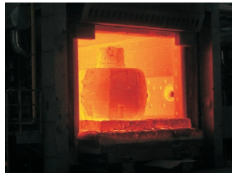
Ogrevanje nakrčenega 45-tonskega ingota pred končnim kovanjem
