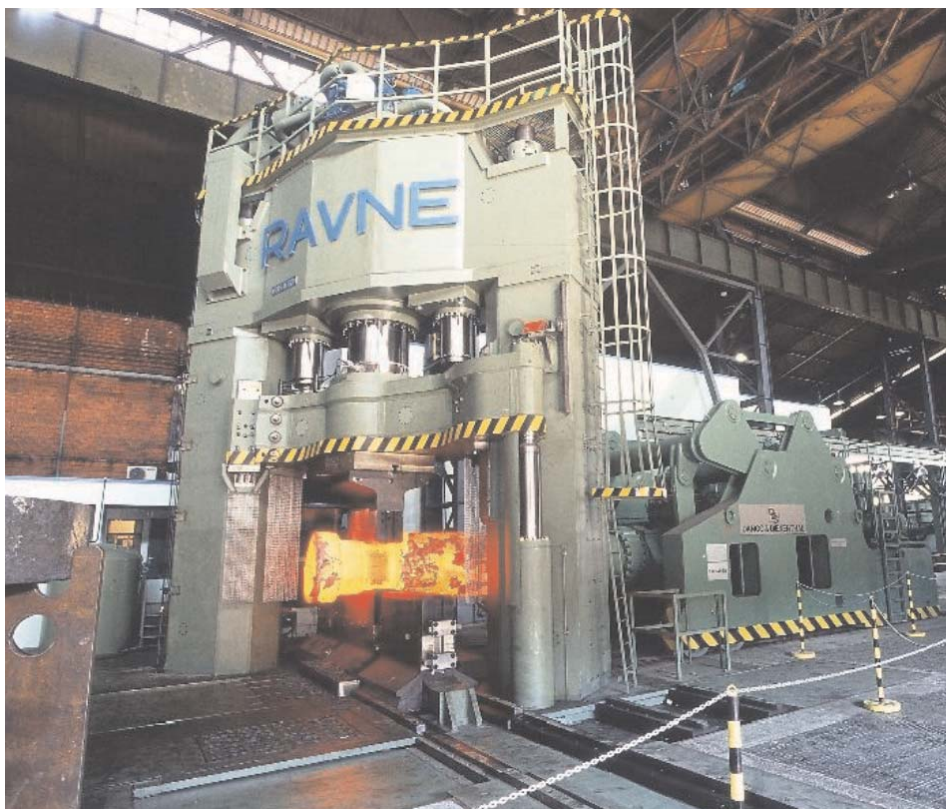
Linija za prosto kovanje s hidravlično stiskalnico 25/30 MN v kovačnici Metal Ravne, zgrajena leta 1999
