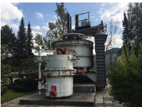
7,5-tonska EOP z zapiralnim drogom izlivka v livnem loncu (FOTO: Slavko Kanalec)
