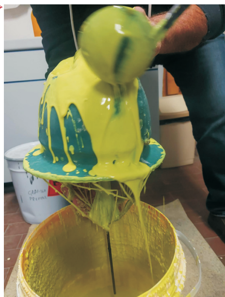
Izdelava keramične školjke na voščnem modelu čelade
