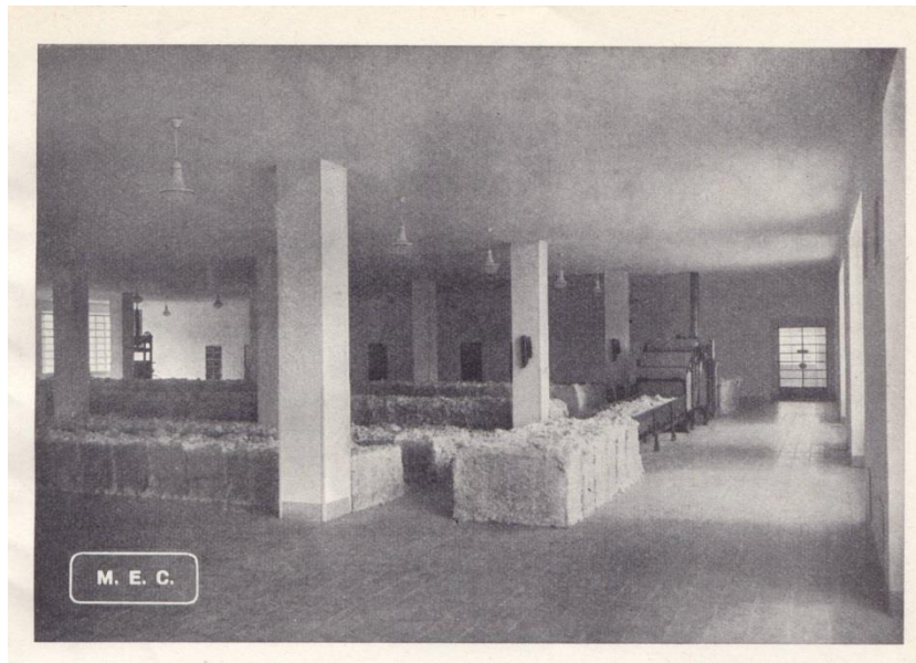
Slika 3.4: Odlagališče odprtih bal različnih predelovalnih partij 1- odlagališče prediva 2- množica odprtih bal, ki predstavlja predelovalno partijo 3- rahljalnik bal z ročno ali avtomatizirano strežbo
