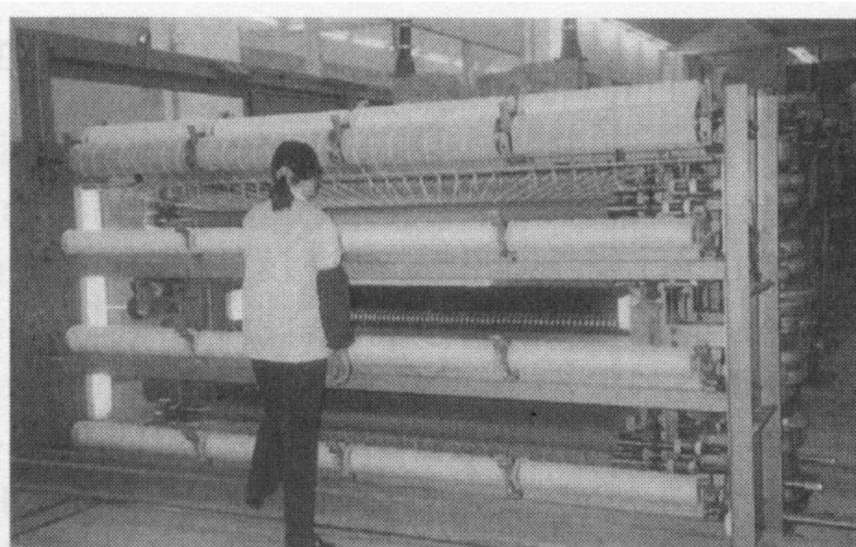
Slika 6.35: Navijalo stenja na mikalniku za volneno mikanko
