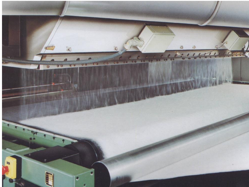
Slika 6.37. Letvasti melt - blowing šobni paket za brizganje štapelnih vlaken (53)
