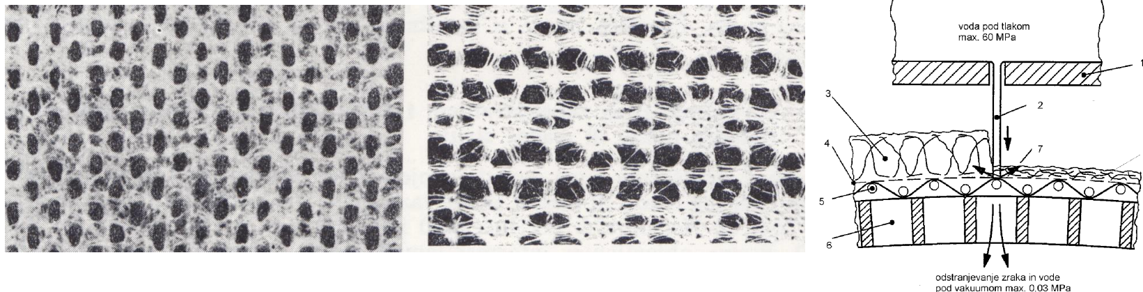
Slika 9.29. Vzorcna struktura koprenske tekstilije, utrjene z vodnim curkom (47)
