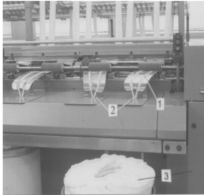
Slika 11.70: Navijalo z odlagalnim lijakom na finiserju FM 5P firme Schlumberger
