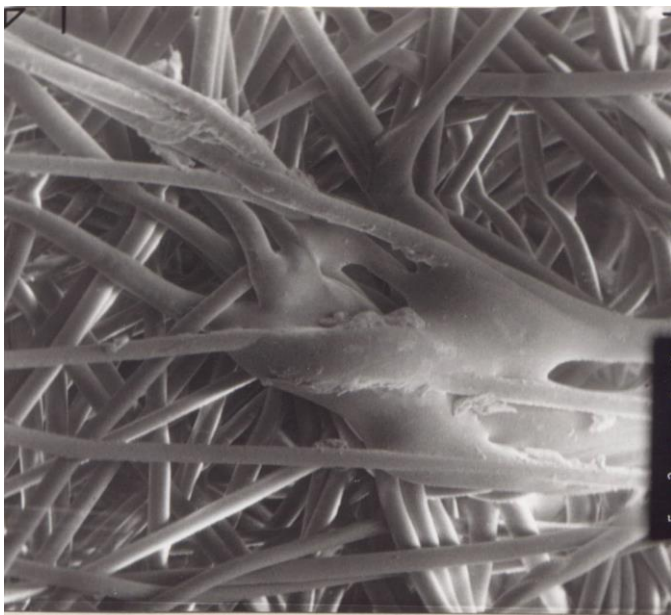
Slika 9.45. Struktura kopenske tekstilije, utrjena s kalandriranjem
