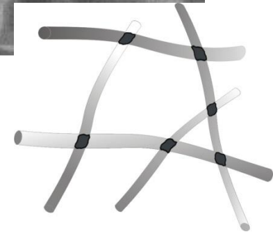
Slika 9.46. Struktura kopenske tekstilije utrjene, z bikomponentnimi vlakni (53)
