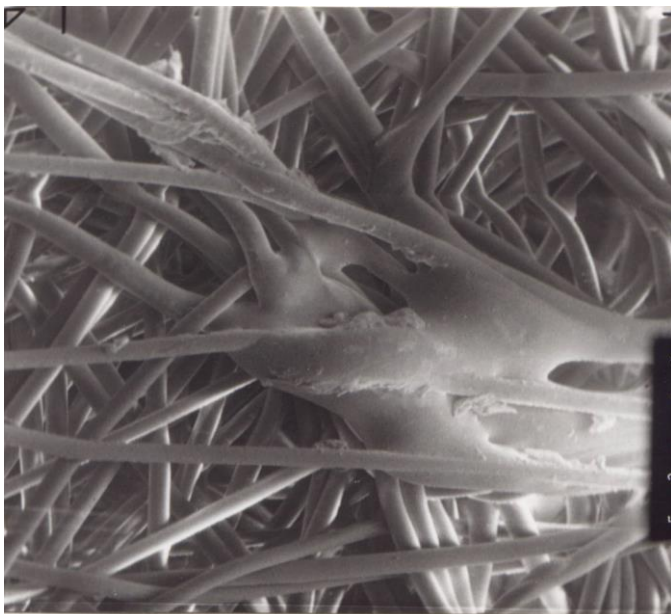
Slika 9.45. Struktura kopenske tekstilije, utrjena s kalandriranjem
