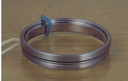
Slika 12.27: Prstan, ki se maže z oljem
