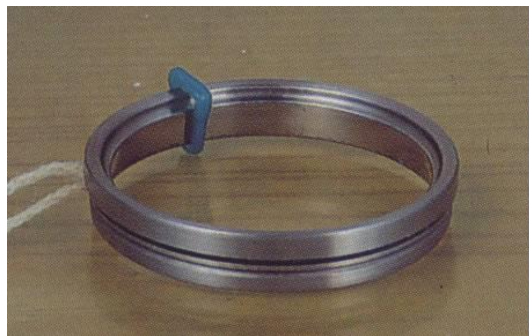
Slika 12.27: Prstan, ki se maže z oljem
