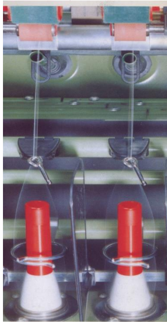
Slika 12.14: Naprava za utrjevanje in navijanje preje na prstanskem predilniku 1- preja 2- vodilo niti 3- kontrolni obroč 4- tekač 5- vreteno - cevka 6- prstan
