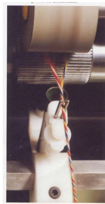
Slika 12.43: SiroSpun ® postopek predenja firme Zinser 1, 4, 6- vodilo stenja v raztezalni 2- pritrdilni vzvod 3, 5, 7- dovajalni, jermenčni in odvajalni raztezalni valjček 8- viličasto vodilo sukane preje 9- sukana preja
