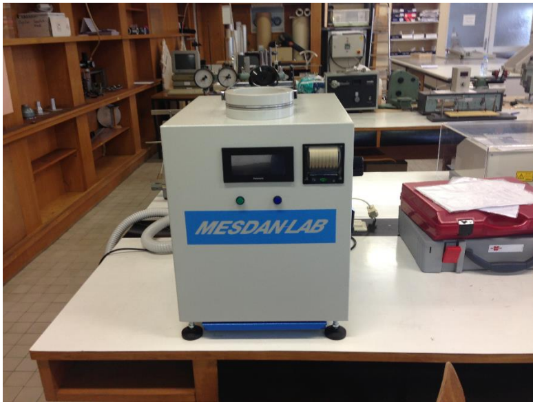
Aparat za merjenje zračne prepustnosti in primer preskusne površine 50 cm 2
