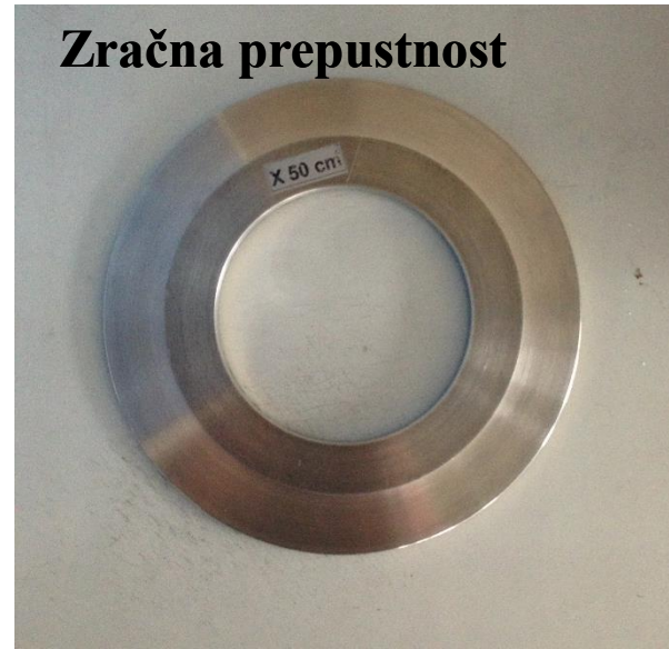
Aparat za merjenje zračne prepustnosti in primer preskusne površine 50 cm 2
