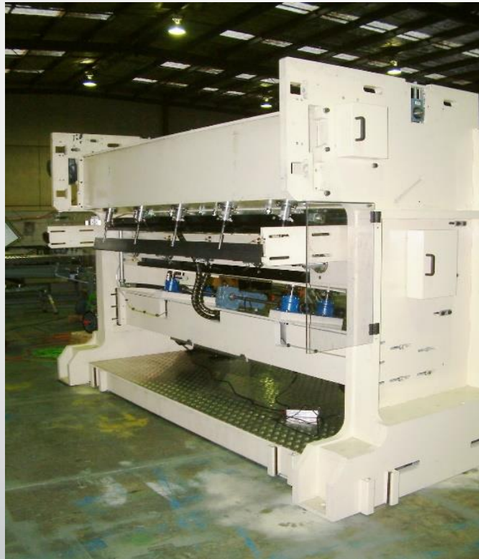
Polagalnik za vertikalno usmerjenost vlaken v kopreni V-lap
