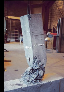
Armiran beton vzdrži večje obremenitve kot navaden
