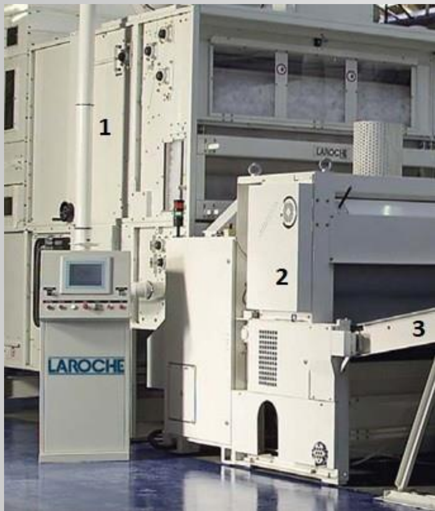
Slika 10: Larochev »Flexiloft« sistem; 1 – napajalnik, 2 – ohišje z sitastim bobnom in sesalom zraka, 3 – zračno položena koprena [8]
