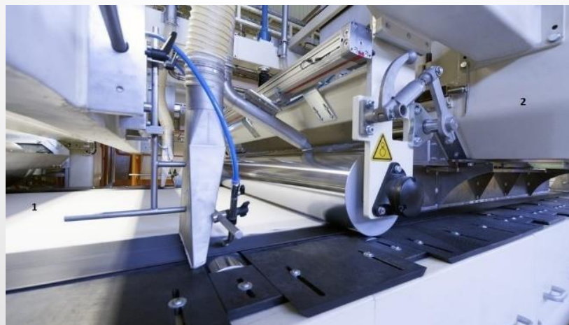
Slika 14: Aerodinamični postopek izdelovalca Oerlikon Neumag za proizvodnjo higienskih tekstilij; 1 – zračni polagalnik, 2 – toplozračni sušilnik za fiksiranje temeljnega sloja [9]
