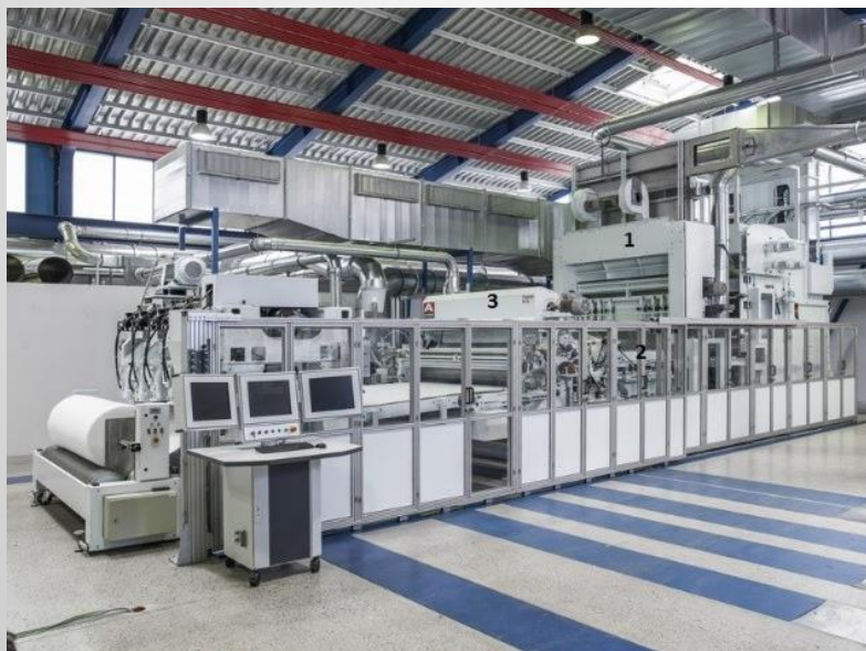
Slika 15: Linija za izdelavo kopren iz recikliranih ogljikovih vlaken; 1 – napajalnik mikalnika, 2 – dovajalni trak z senzorjem za maso dovajanega koprenskega runa, 3 – mikalnik K12 in izdelana koprena[10]
