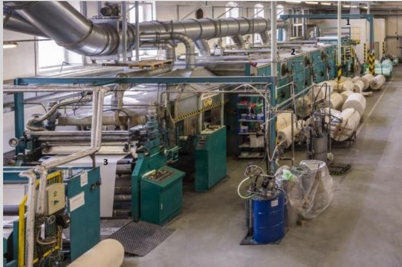
Slika 22: Gumotexova linija, ki je bila ponovno predstavljena za premazane tekstilije; 1 – dovajalni valj, 2 – kompenzator napetosti, 3 – premazovalna valja, 4 - navijanje premazane koprene[14]
