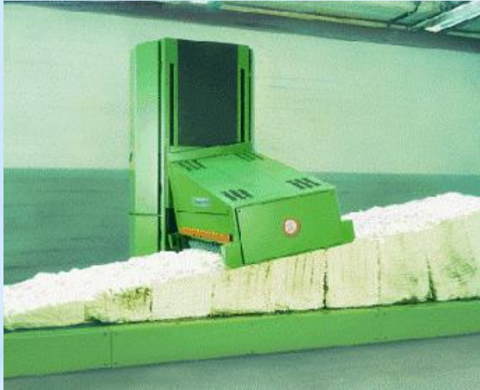
Fig.3: Bale opener Trüschler BLENDOMAT BDT 020
