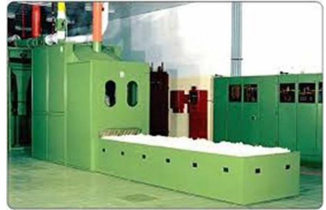
Slika 5.2. Rahljalnik bal s poševnim iglastim trakom firme Temafa 1- dovajalni letvasti trak 2- dovajalni trak 3- poševni iglasti trak 4- vračalni valj 5- snemalni valj 6- odvod zrahljanih kosmov prediva
