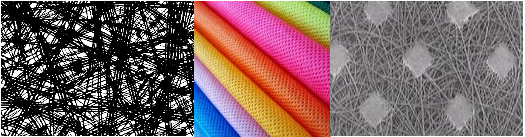
Slika 6.34. Struktura spunbonding koprene, utrjene s termo kalandrom
