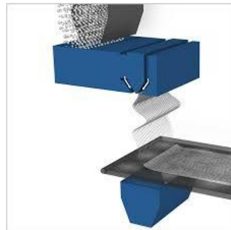
Slika 6.35. Melt - blowing postopek izdelave samodejno utrjene ekstrudirane koprene 1- zbiralnik rezancev 2- ekstrudor 3- zobniška črpalka 4- letvasti šobni paket 5- sitasti boben 6- ekstrudirana koprena 7- navijalo koprene
