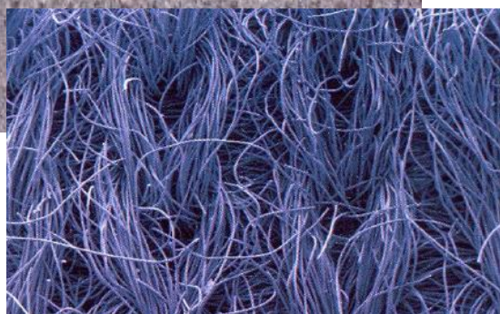
Slika 9.33. Arabewa prešivalnik z lastnimi snopiči vlaken
